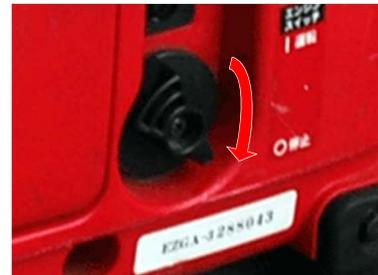
9 停止するときは、使用器具をスイッチを切ってプラグを抜いてから、エンジンスイッチを『停止』の位置に合わせます。
