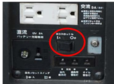
8 電気を取り出していない時に『エコスロトル』スイッチを『入』にすると自動的にエンジン回転が下がります。
