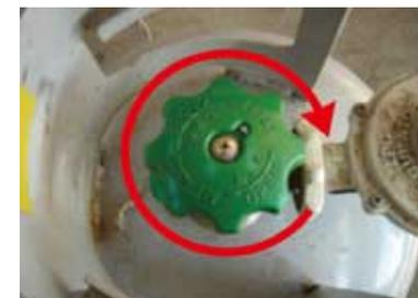
12 消火したことを確認したら、本体の元栓を閉めて、プロパンガスの元栓を完全に閉めます。
